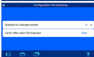
Auf dieser Seite kann eingestellt werden, wie lange die Filterpumpe beim Verfahren der Rückspül-Stangenventile ausgeschaltet werden soll.
