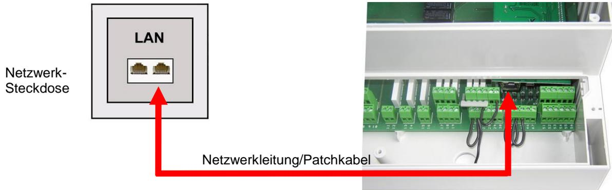
Nachdem die POOLcontrol-40.net mit einer aktiven Netzwerksteckdose verbunden wurde, kann die Spannungsversorgung eingeschaltet werden. Der **osf**-Webserver in der POOLcontrol-40.net sucht nun eigenständig den **osf**-Kommunikationsserver und meldet sich in dessen Datenbank an.
